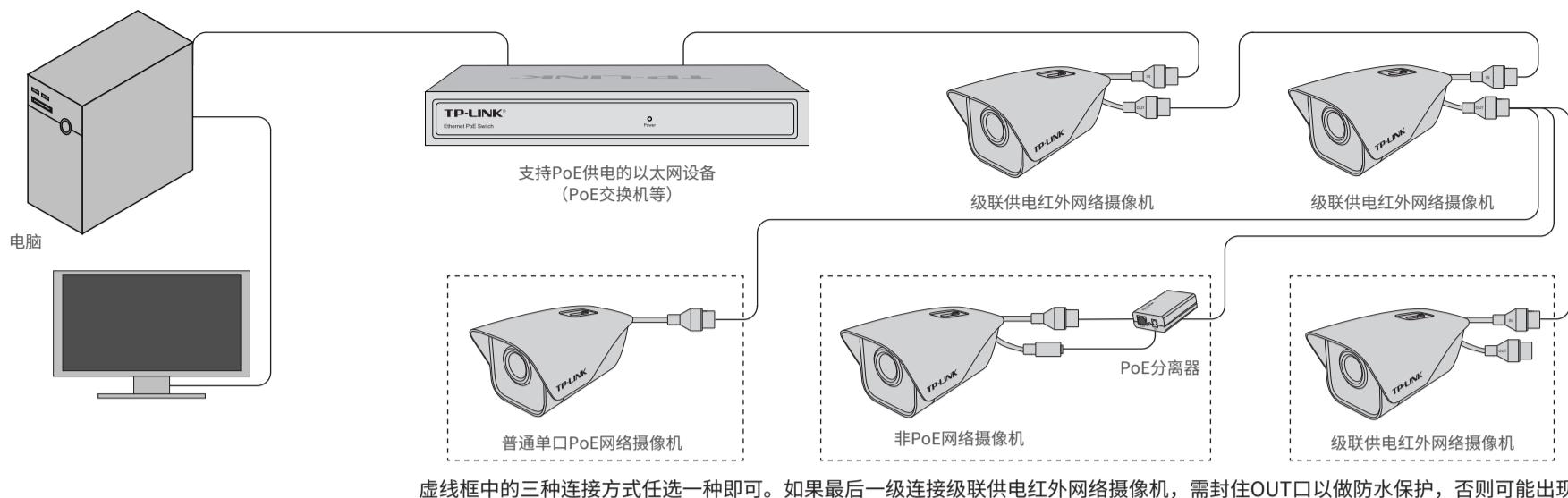
虚线框中的三种连接方式任选一种即可。如果最后一级连接级联供电红外网络摄像机，需封住OUT口以做防水保护，否则可能出现短路风险。
