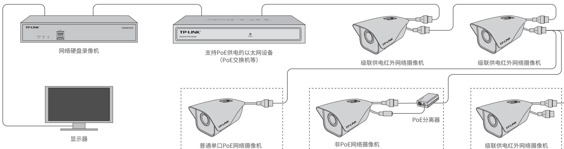
虚线框中的三种连接方式任选一种即可。如果最后一级连接级联供电红外网络摄像机，需封住OUT口以做防水保护，否则可能出现短路风险。
